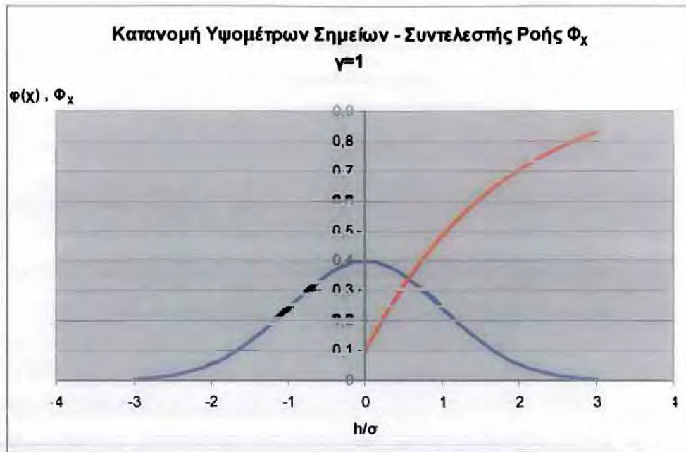
Σχήμα 1.4.3.2 : Συνάρτηση Κατανομής υψομέτρων σημείων τραχείας επιφάνειας που λιπαίνεται υδροδυναμικά καθώς και διάγραμμα μεταβολής του αντίστοιχου συντελεστή ροής.
