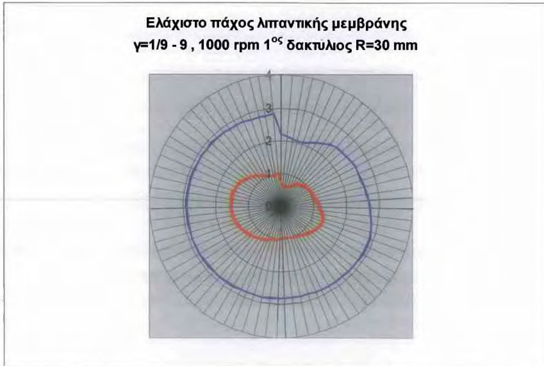
Σχήμα 4.1 : Συγκριτικό πολικό διάγραμμα μεταβολής ελάχιστης τιμής λιπαντικής μεμβράνης για \gamma=1/9 και \gamma=9 για \eta=10 mPas p_{tar}=0.2 MPa Κατάσταση φθοράς 1 (μπλε) , Κατάσταση φθοράς 2 (κόκκινο) ANΣ βοράς , ΚΝΣ νότος , 2 χρόνοι κύκλου 4x Μ.Ε.Κ. (εκτόνωση-εξαγωγή)
