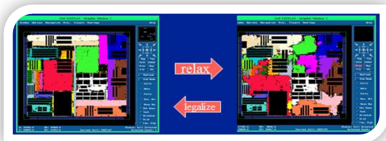
Εικόνα 4.4: Χαλάρωση του προβλήματος τοποθέτησης σε πρόβλημα χωροθέτησης.
