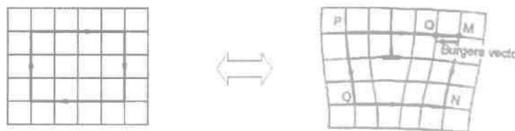
Εικόνα 2.2: Ορισμός διανύσματος του Burger και της γραμμής κατεύθυνσης στον διαταραγμένο κρύσταλλο. [http://en.wikipedia.org/wiki/Dislocation]
