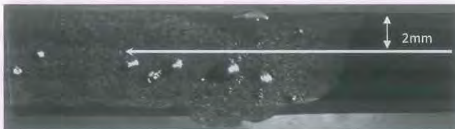
Σχήμα 3.5: Σχηματική αναπαράσταση του τρόπου μικροσκληρομέτρησης σε διαμήκεις τομές
