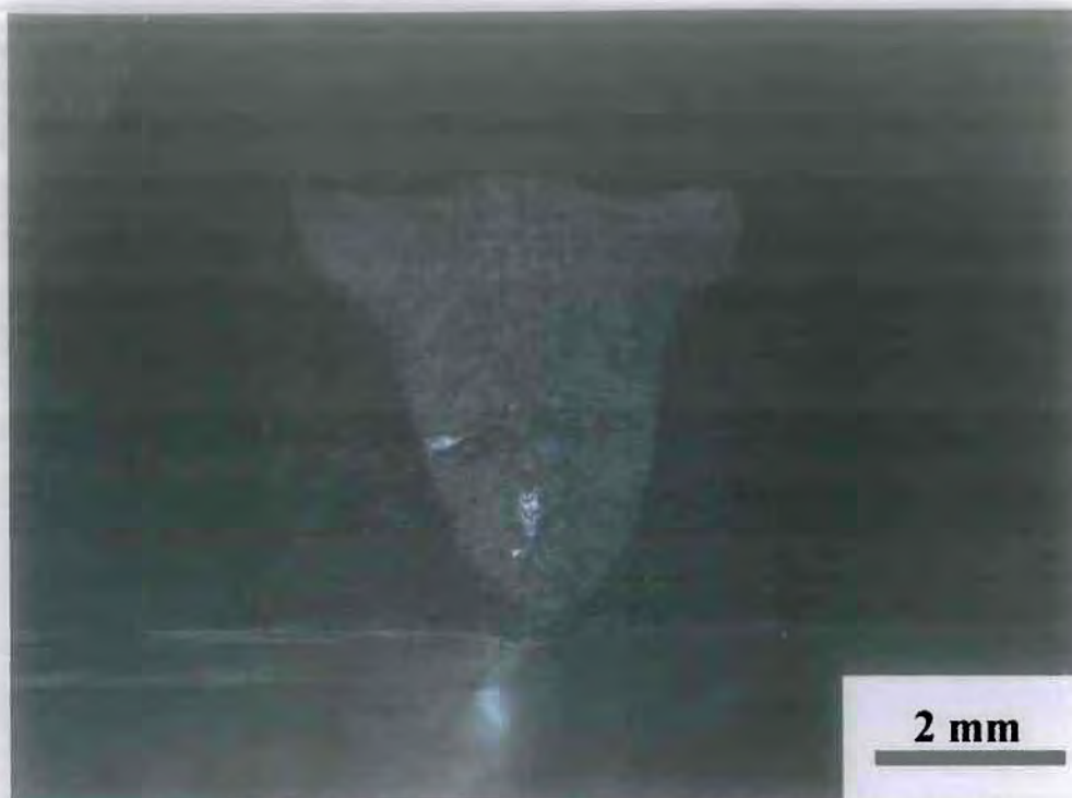
Σχήμα 4.91: Δοκίμιο 4 (2139) - Μακροδομή συγκόλλησης (Εγκάρσια τομή) (Ισχύς: 3818 W, Ταχύτητα: 1.6 m/min, ΡΠΘ: 143 J/mm)
