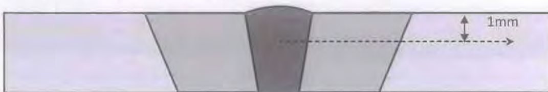
Σχήμα 3.4: Σχηματική αναπαράσταση του τρόπου μικροσκληρομέτρησης σε εγκάρσιες τομές
