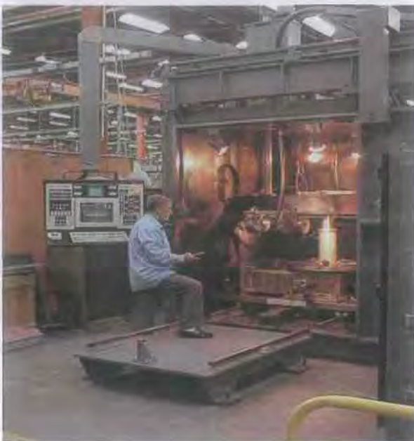
Σχήμα 3.3: Χαρακτηριστικά διάταξης EBW που χρησιμοποιήθηκε στα πειράματα (EAB).
