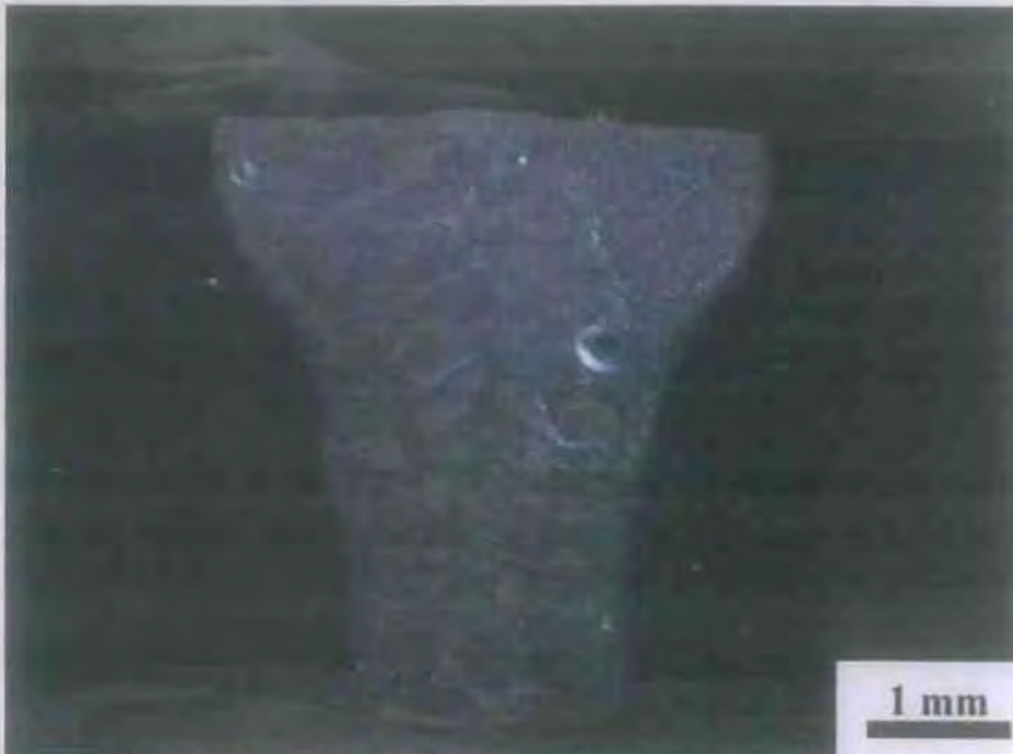
Σχήμα 4.89: Δοκίμιο 5 (2198) - Μακροδομή συγκόλλησης (Εγκάρσια τομή) (Ισχύς: 3064 W, Ταχύτητα: 2 m/min, ΡΠΘ: 92 J/mm)
