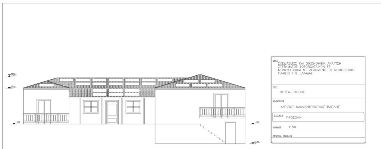
Σχήμα 42 : Νότια όψη μονοκατοικίας μετά την τοποθέτηση των πλαισίων
