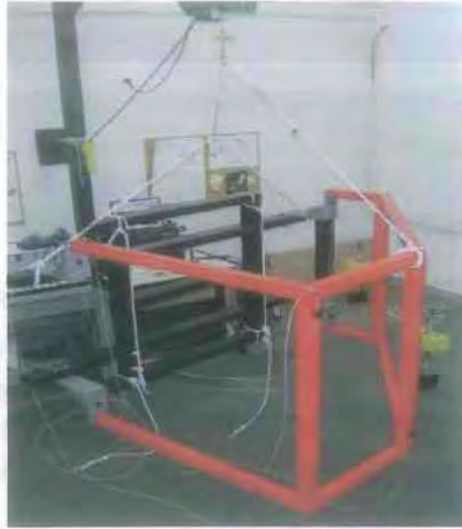
Σχήμα 4.2: Εικόνα του πειραματικού οχήματος κατά την μέτρηση των ιδιοσυχνοτήτων του
