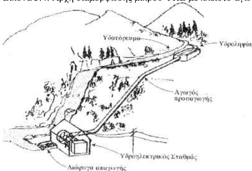
Εικόνα 3.4: Αρχή διαμόρφωσης μικρού ΥΗΕ με κλειστό αγωγό προσαγωγής
