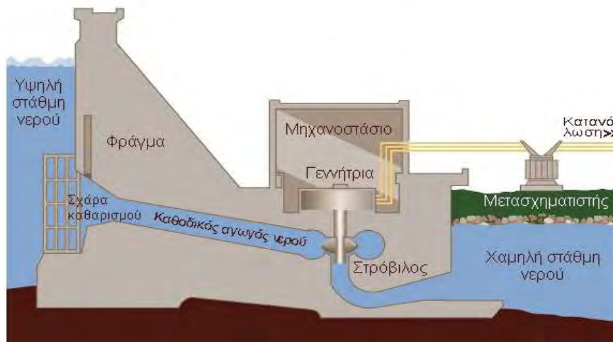
Εικόνα 3.2: Σχηματική παράσταση παραγωγή ενέργειας σε υδροηλεκτρικό σταθμό
