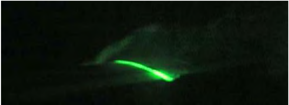
Φωτογραφία 28. Η ροή λίγο πριν την απώλεια στήριξης ( 15^{\circ} ) σε στρωτή ροή
