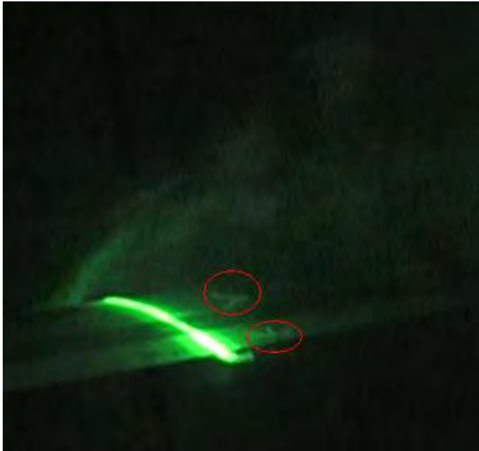
Φωτογραφία 35. Η ροή μετά την απώλεια στήριξης ( 19^\circ+ ) σε τυρβώδη ροή
