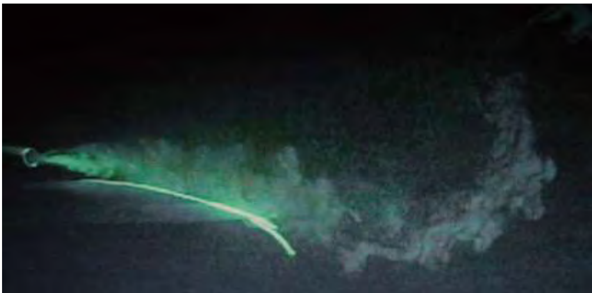
Φωτογραφία 49. Ταλάντωση με f = 4\text{Hz} / γωνία προσβολής +12^\circ / σε τυρβώδη ροή
