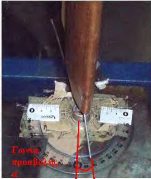
Φωτογραφία 12. Ο τρόπος ανάγνωσης της γωνίας προσβολής του μοντέλου
