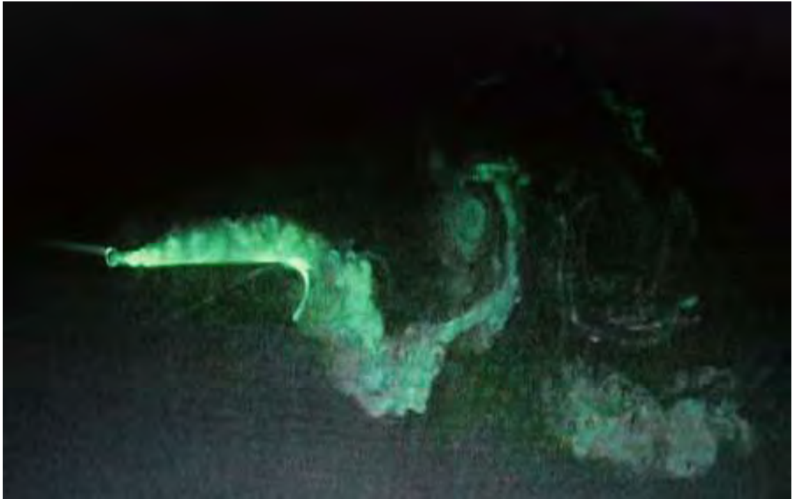
Φωτογραφία 44. Ταλάντωση με f = 8\text{Hz} / γωνία προσβολής -12^\circ / σε στρωτή ροή
