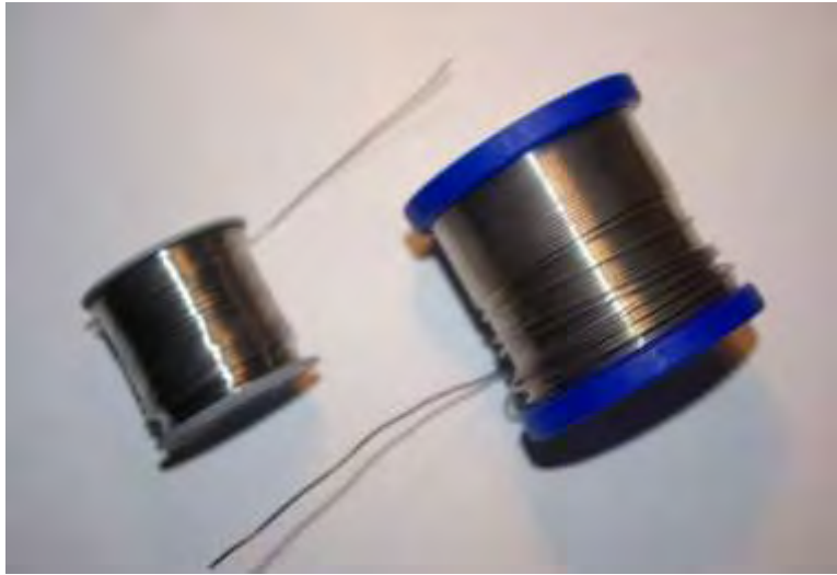
Εικόνα 6. Σύρματα συγκόλλησης ηλεκτρονικών εξαρτημάτων που περιέχουν μόλυβδο (Πηγή: Προσωπικό αρχείο Δ. Πουρνάρα).
