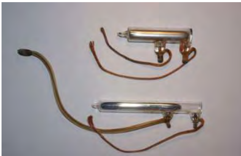
Εικόνα 7. Διακόπτες από αμπούλες υδραργύρου που χρησιμοποιούνται σε θερμοστάτες εσωτερικών χώρων (Πηγή: Προσωπικό αρχείο Δ. Πουρνάρα).
