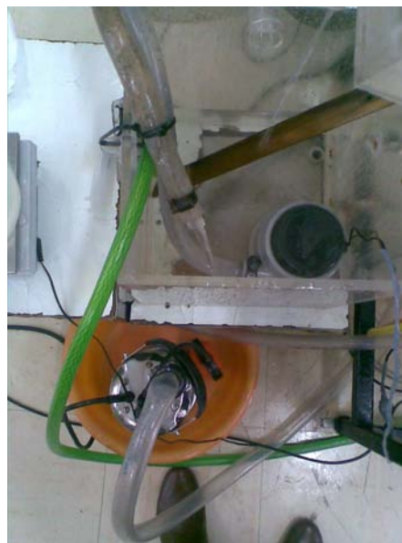
Σχήμα 3.10 Δοχείο συλλογής και εμβαπτιζόμενη αντλία
