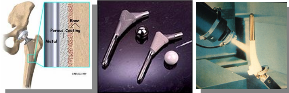
EIKONA 33. Α. Σχηματική απεικόνιση της διεπιφάνειας με υλικά με επικάλυψη HA. Β. Στελεοί με και χωρίς επικάλυψη. Γ. Plasma deposition process
