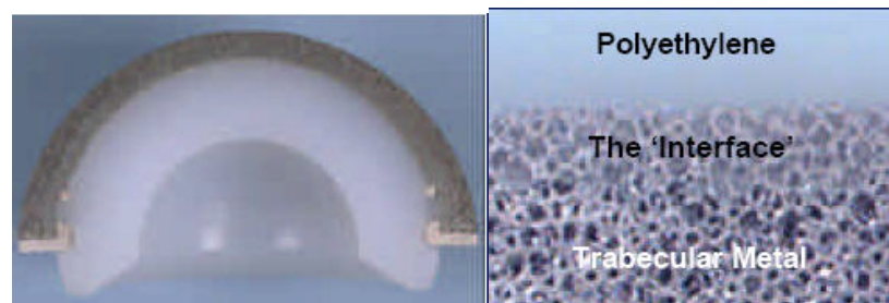
ΕΙΚΟΝΑ 60. Τομή του κυπέλλου και σχηματική αναπαράσταση της διεπιφάνειας TMT-πολυαιθυλενίου. Το πλαστικό διεισδύει στους πόρους και σταθεροποιείται με πίεση.
