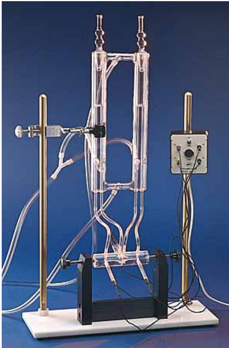
Εικόνα 8: Η συσκευή τύπου Ussing DVC - 1000 (World Precision Instruments, Sarasota, USA) που χρησιμοποιήθηκε για την μέτρηση των ηλεκτροφυσιολογικών παραμέτρων.
