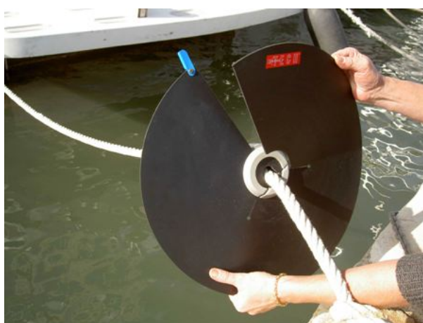
Εικόνα 57: Ειδικά κωνικά εμπόδια αποκλεισμού τρωκτικών τοποθετημένα σε κάβους πλοίων. Πηγή:
