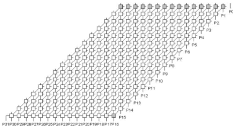
Εικόνα 62. Το κύκλωμα αναφοράς c6288 της οικογένειας ISCAS85.
