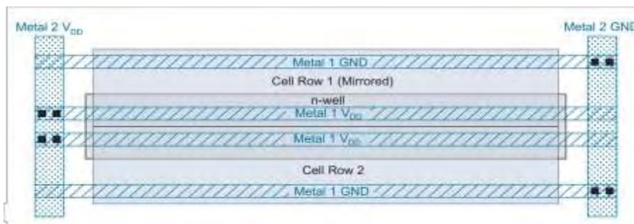
Εικόνα 33. Το ΔΔΙ ισχύος στο χαμηλότερο επίπεδο για την διασύνδεση std cell [Harris].
