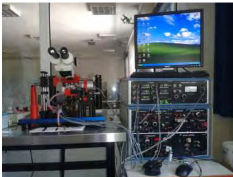
Εικόνα 31. Πειραματική διάταξη αξιολόγησης λειτουργικών ιδιοτήτων απογυμνωμένων μυϊκών ινών SI Heidelberg.
