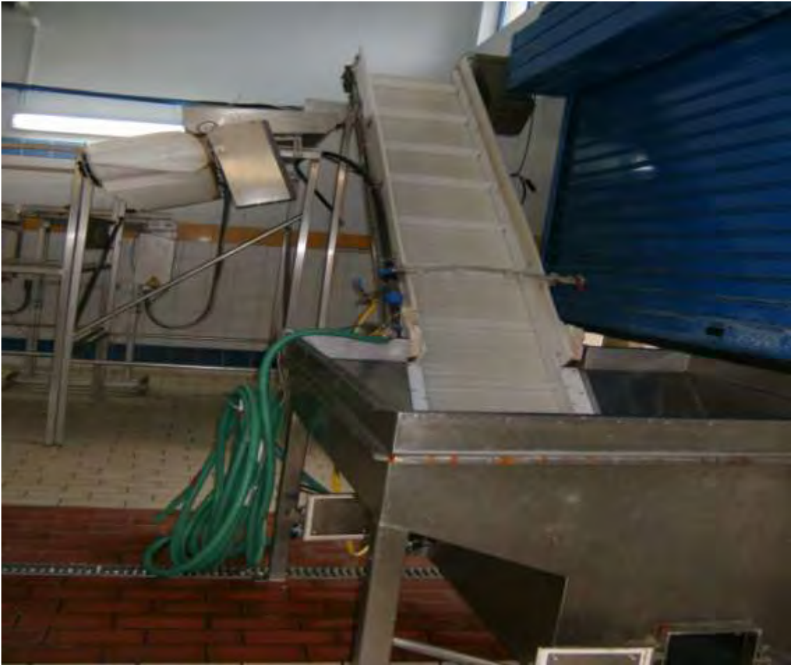
Εικόνα 4.2 : Αναβατήριο που μεταφέρει τα ψάρια στο διαλογέα στα αριστερά. (Προσωπικό αρχείο).
