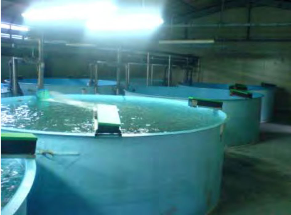
Εικόνα 3.2 : Κυκλικές δεξαμενές προπάχυνσης ιχθυοδίων τσιπούρας 20m 3 (Προσωπικό αρχείο)
