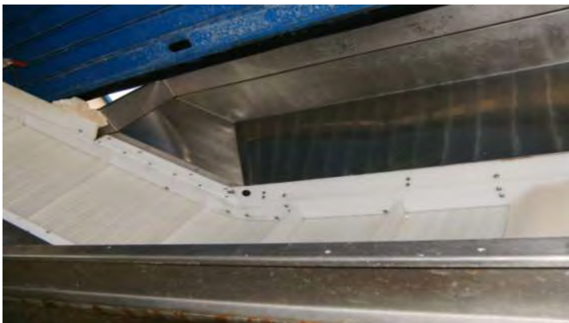
Εικόνα 4.1 : Χοάνη ανατροπής της βούτας με τα ψάρια (Προσωπικό αρχείο).
