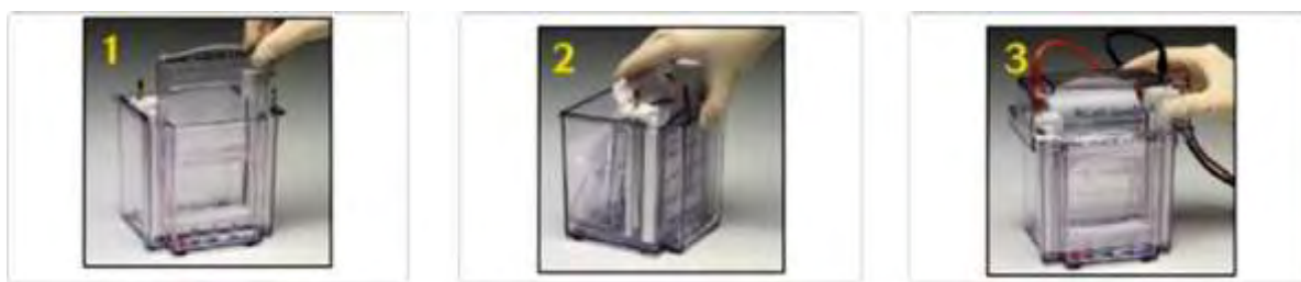
Εικ. 10 Απεικόνιση του τρόπου προετοιμασίας της συσκευής για την ηλεκτροφόρηση των πρωτεϊνικών δειγμάτων. [ http://www.lifetechnologies.com/1/1/14473-xcell-surelock-mini-cell-xcell-ii-blot-module.html ]
