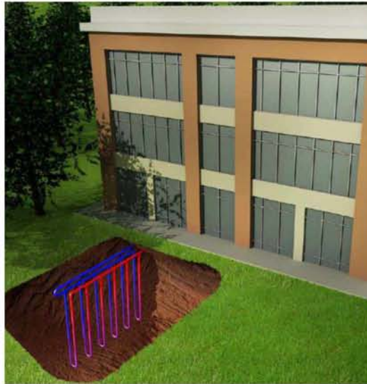
Εικόνα 3.5. Κάθετη εγκατάσταση του εναλλάκτη θερμότητας κλειστού κυκλώματος. [13]
