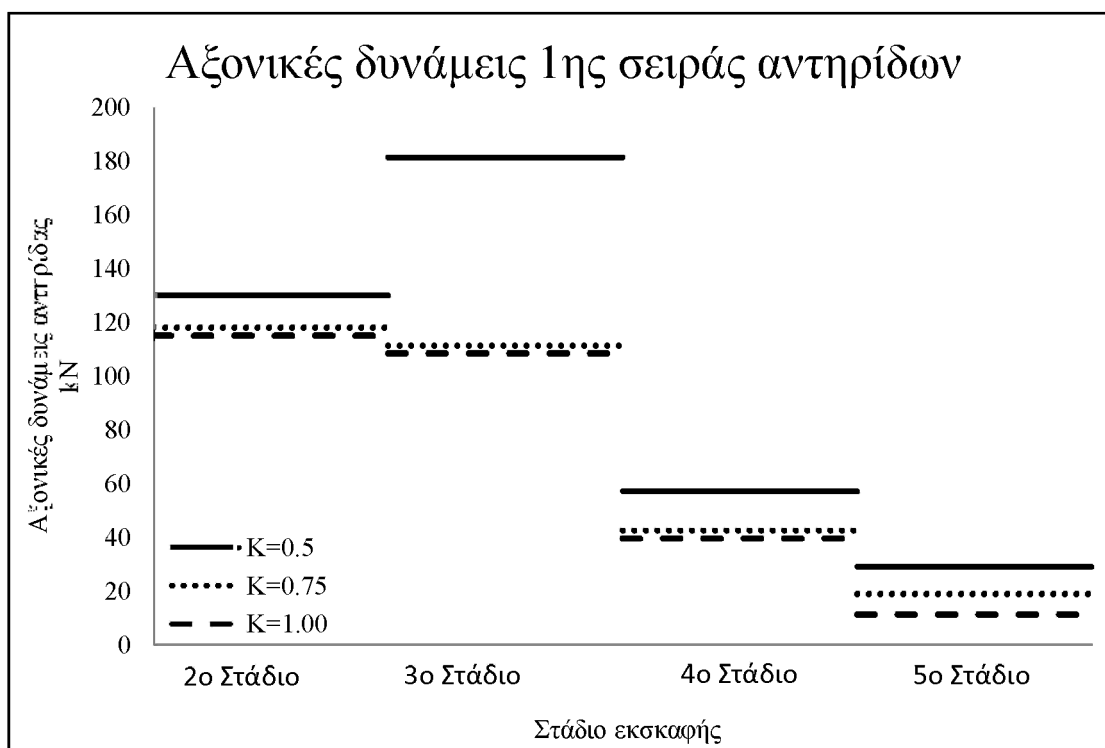
Σχήμα 4.27 Αξονικές δυνάμεις 1 ης σειράς αντηρίδων για διάφορες τιμές του συντελεστή ωθήσεων ηρεμίας K_0 με χρήση καταστατικού νόμου Double-Yield σε όλα τα στάδια εκσκαφής
