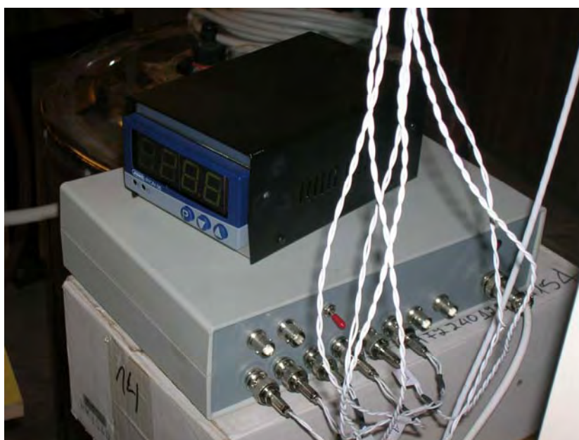
Σχήμα 2.9 Προενισχυτής σήματος thermistors και καταγραφικό θερμοκρασίας εισόδου.
