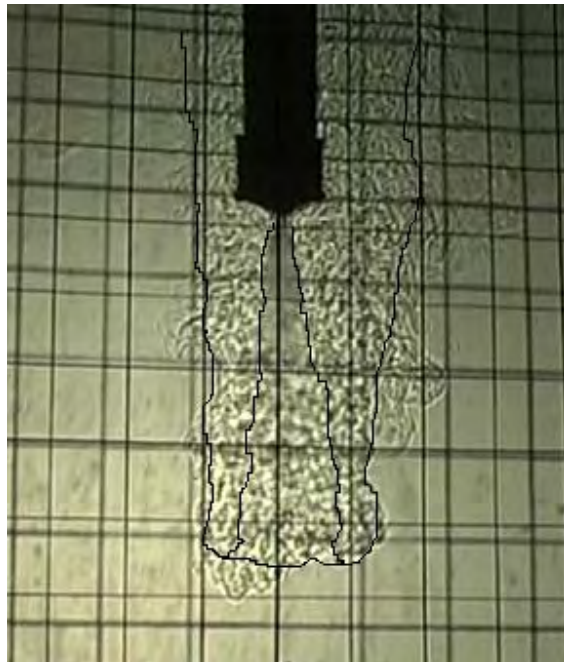
Σχήμα 3.11 Φωτογραφία της φλέβας όπου διακρίνονται οι περιοχές της ανερχόμενης και της κατερχόμενης ροής καθώς και η γωνία \varphi
