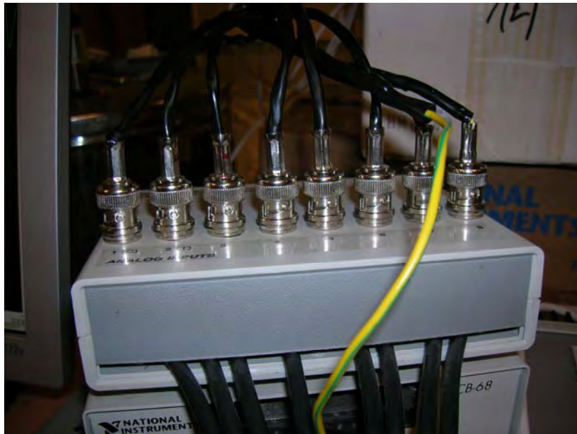
Σχήμα 2.10 Μετατροπέας αναλογικού σήματος thermistors σε ψηφιακό.
