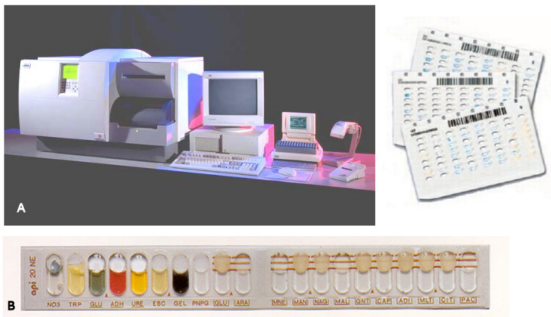
Εικόνα 1: Το αυτοματοποιημένο σύστημα VITEK ® 2 με τις μήτρες ταυτοποίησης μίας χρήσης (A) και η ταινία των βιοχημικών δοκιμασιών του ημιαυτόματου συστήματος API 20NE (B).
