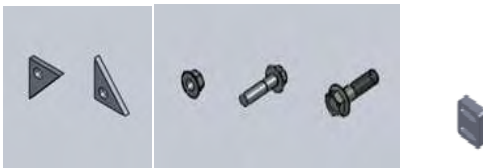
Σχήμα 2.2.3: Τα τρίγωνα, οι βίδες και η μάζα στο SolidWorks
