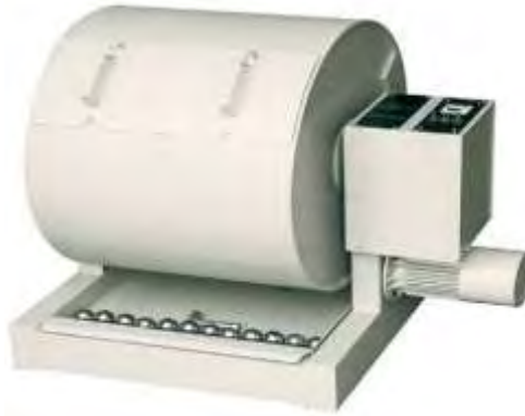
Εικόνα 3.4: Συσκευή Los Angeles για τον προσδιορισμό των αντοχών σε τριβή και κρούση των αδρανών υλικών ( http://www.controls.it ).
