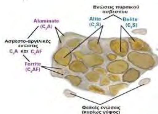
Εικόνα 2.12: Κόκκος τσιμέντου στον οποίο εμφανίζονται οι διάφορες φάσεις του κλίνκερ που ενυδατώνονται (Τσακαλάκης, 2010).
