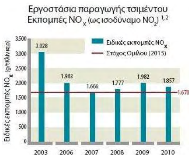
Σχήμα 5.7: Παρουσίαση ειδικών εκπομπών NO x (gr NO x / t κλίνκερ) των εργοστασίων παραγωγής τσιμέντου, μεγάλης ελληνικής τσιμεντοβιομηχανίας (www.titan.gr/userfiles/File/csr2010/CSR_GR.pdf, ίδια επεξεργασία).
