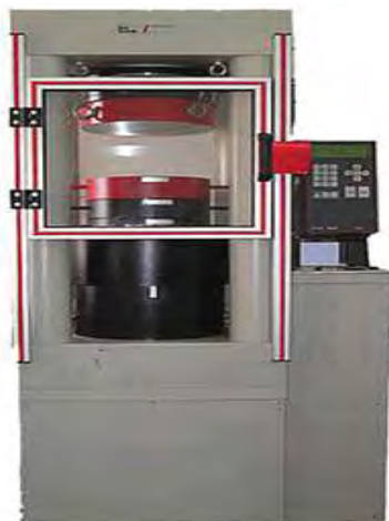
Εικόνα 2.2: Συσκευή ποιοτικού ελέγχου αντοχής σε θλίψης δοκιμίων ( http://www.eds.gr ).
