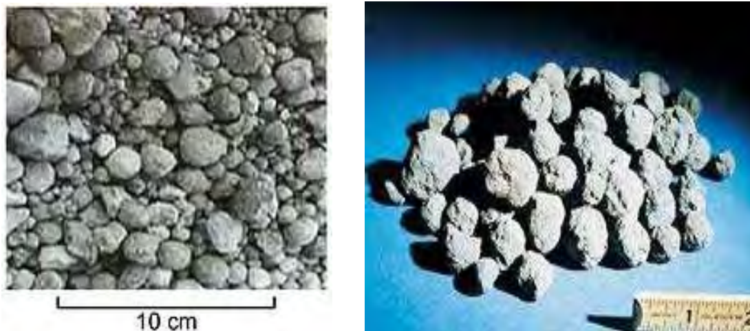
Εικόνα 2.6: Σφαιρίδια (pellets) μεγέθους 10,00–25,00 mm του κλίνκερ τσιμέντου. Προϊόν της διεργασίας της ένησης στην περιστροφική κάμινο.
