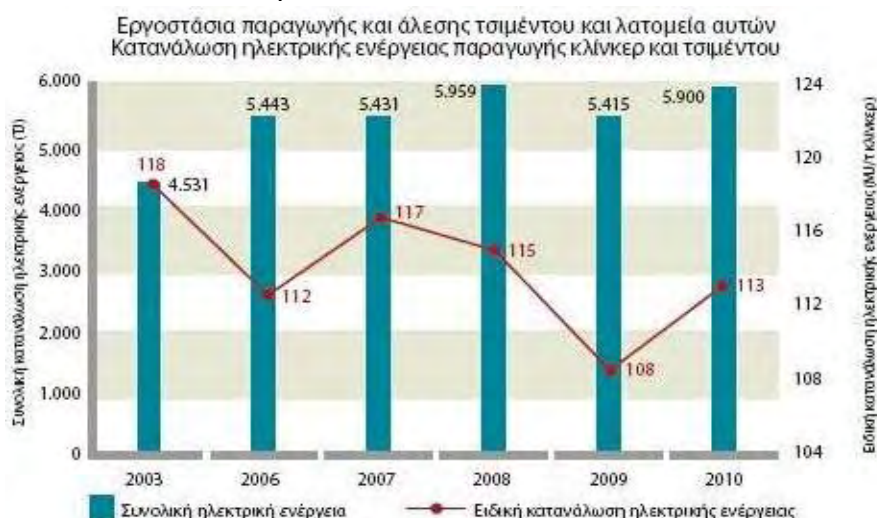
Σχήμα 6.6: Συνολική κατανάλωση ηλεκτρικής ενέργειας (TJ) και ειδική κατανάλωση ηλεκτρικής ενέργειας (MJ/τον κλίνκερ) για την παραγωγή κλίνκερ και τσιμέντου, των εργοστασίων παραγωγής και άλεσης τσιμέντου και των λατομείων, μεγάλης ελληνικής τσιμεντοβιομηχανίας ( www.titan.gr , ίδια επεξεργασία).
