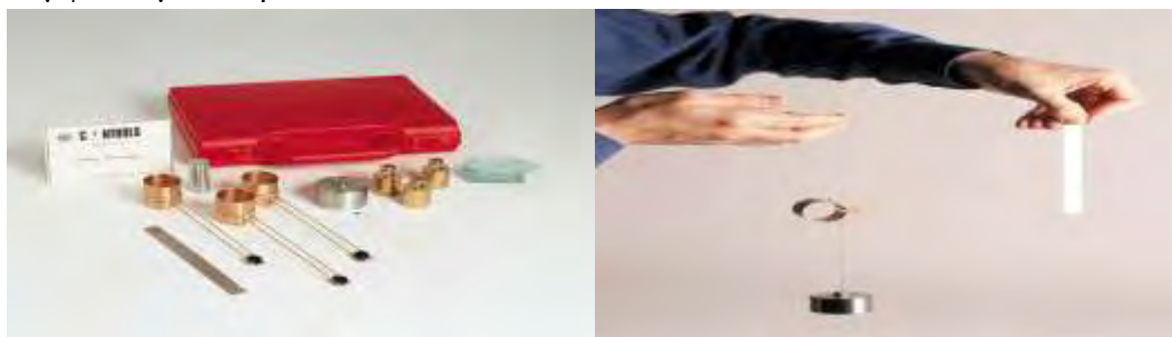
Εικόνα 2.4: Συσκευή Le Chatellier για τον προσδιορισμό της ογκοσταθερότητας του τσιμέντου ( http://www.controls.it ).
