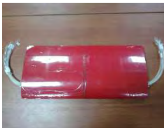
Σχήμα 11 Θέσεις των οπών στατικής πίεσης στο μέσον της αεροτομής
