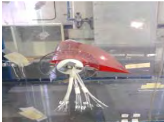
Σχήμα 10 Η αεροτομή μέσα στο τμήμα δοκιμών της αεροσήραγγας
