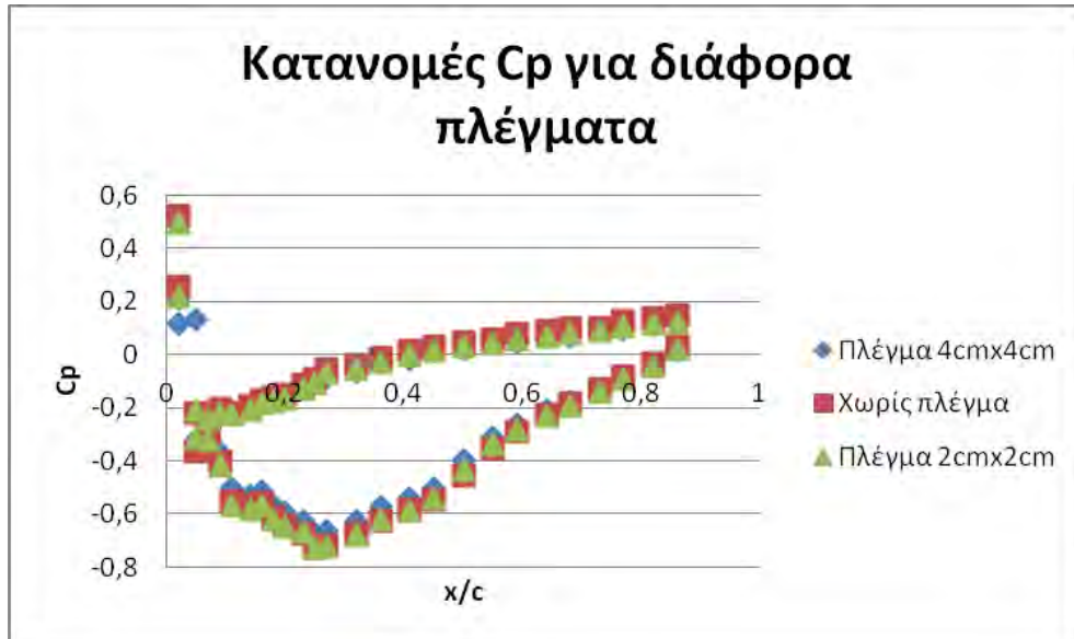
Σχήμα 75 Σύγκριση συντελεστή πίεσης για λεία αεροτομή με και χωρίς πλέγμα ( \alpha=0^\circ , V=10\text{m/s} )
