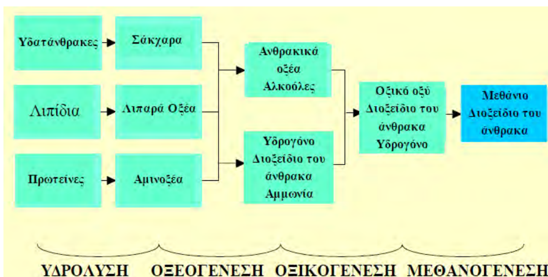
Σχήμα 2.2: Τα κύρια βήματα της διεργασίας της αναερόβιας χώνευσης (Al. Seadi, 2003).
