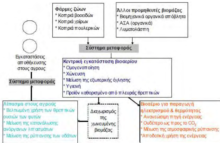
Σχήμα 4.2: Τα κύρια ρεύματα της ολοκληρωμένης βασικής αρχής των κεντρικών εγκαταστάσεων χώνευσης (Holm-Nielsen, et al., 2009).
