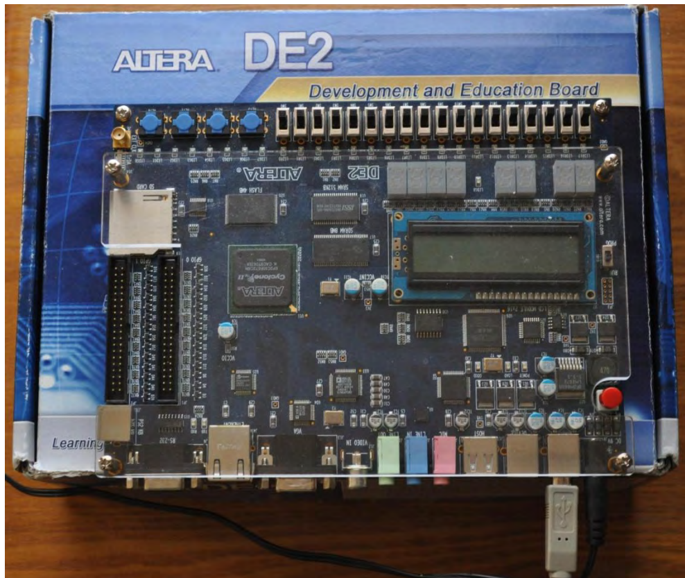
Εικ. 7-1: Το Altera DE2 board που χρησιμοποιήσαμε για να κατεβάσουμε τις τρεις σχεδιάσεις των επεξεργαστών που παρουσιάστηκαν στα Κεφ. 4, 5 και 6.
