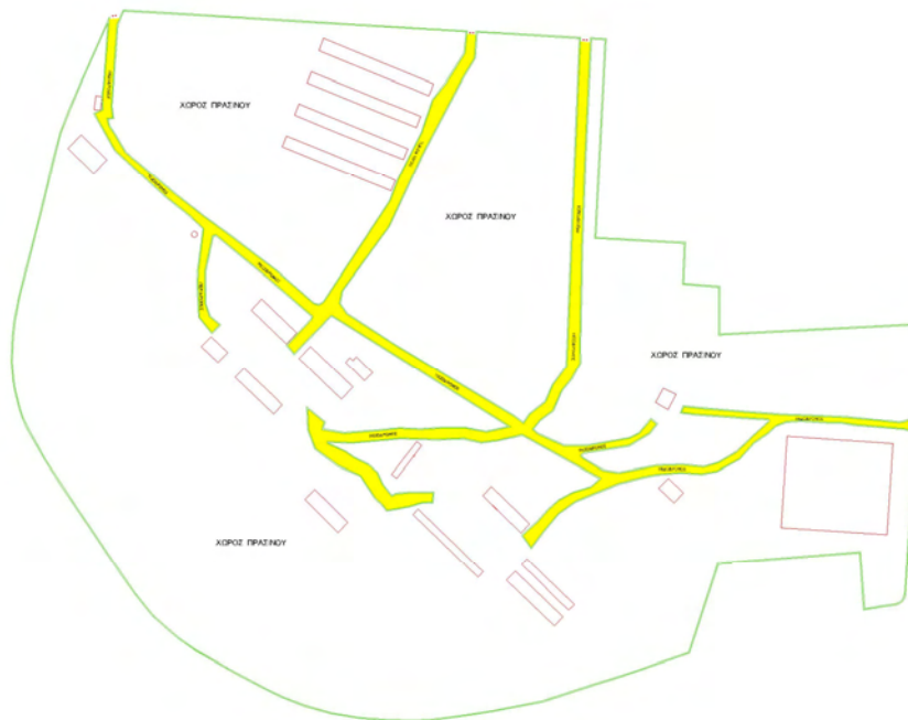
Εικ. 150: Προτεινόμενο Ρυμοτομικό Σχέδιο. (Κόκκινο: οικοδομική γραμμή, Πράσινο: ρυμοτομική γραμμή, Κίτρινο : πεζόδρομοι. Στο λεκτικό της ρύθμισης να αναγράφεται «τα κτίρια παραμένουν ως έχουν σε επίπεδο περιγράμματος και ύψους».
