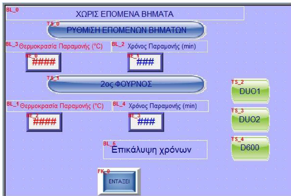
Εικόνα 2.2.2.2 Παράθυρο προγραμματισμού εργασιών για την αυτόματη διεκπεραίωση της θερμικής κατεργασίας.
