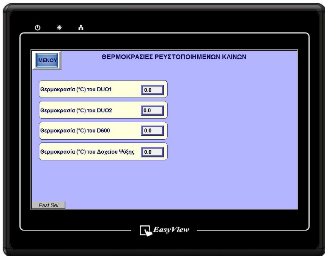
Εικόνα 2.2.2.8 Καρτέλα «ΘΕΡΜΟΚΡΑΣΙΕΣ» Οθόνη απεικόνισης των θερμοκρασιών των κλιβάνων και του δοχείου ψύξης.
