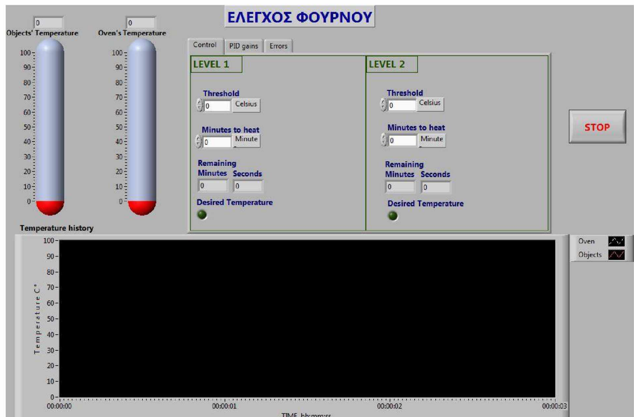
Εικόνα 2.1.3.1 Πάνελ προγράμματος ελέγχου της θερμοκρασίας και του χρόνου θέρμανσης ενός κλιβάνου, με τη χρήση των παραμέτρων PID – Καρτέλα ελέγχου των θερμοκρασιών και του χρόνου παραμονής στην επιθυμητή θερμοκρασία.
