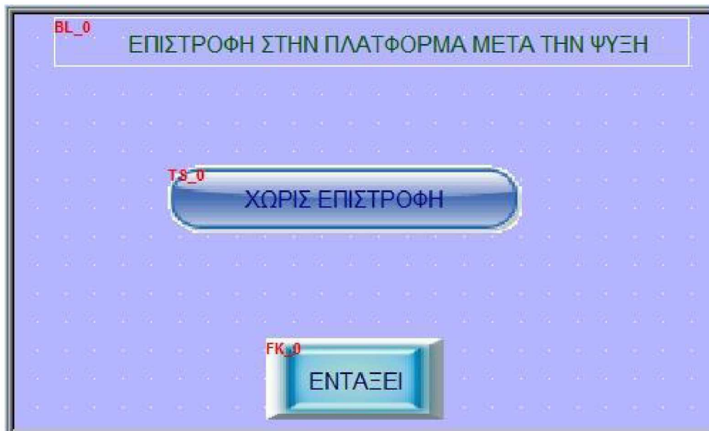
Εικόνα 2.2.2.3 Παράθυρο προγραμματισμού μεταφοράς καλάθιού από το δοχείο ψύξης στην Πλατφόρμα 1 ή 2 στο τέλος της θερμικής κατεργασίας. Αυτό το παράθυρο διαλόγου εμφανίζεται μόνο αν επιλεγθεί κάποια ενέργεια προς το δοχείο ψύξης και όχι προς κάποιο κλίβανο.
