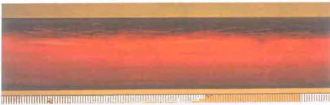
(β) U_{LS}=0,1 m/s και U_{GS}=2,5 m/s Η υγρή μάζα (plug) που φράσει την διατομή
