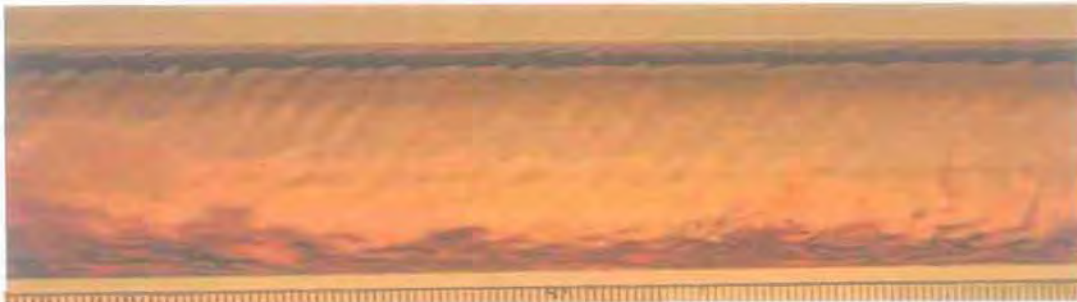
(β) U_{LS}=0,072 m/s και U_{GS}=18,9 m/s Δακτυλιοειδής ροή
