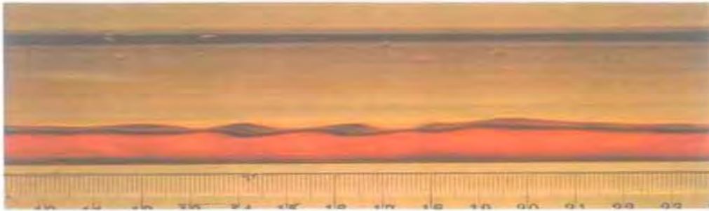
(α) U_{LS}=0,03 m/s και U_{GS}=6,6 m/s διδιάστατα κύματα μεγάλου μήκους (2D)
