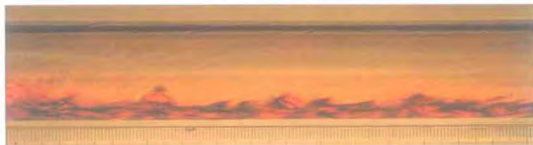
(γ) U_{LS}=0,03 m/s και U_{GS}=14 m/s εκνέφωση (atomization)
