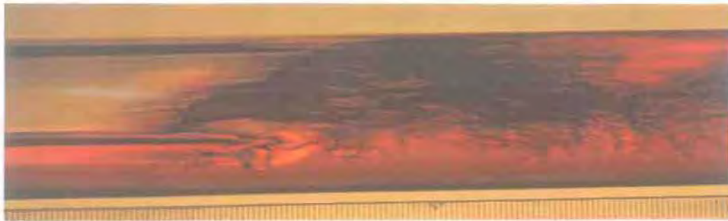
(α) U_{LS}=0,1 m/s και U_{GS}=2,5 m/s Μπροστινό τμήμα του «plug»
