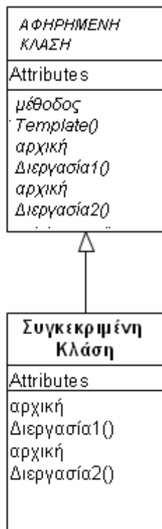
Σχήμα 5.12.1 Απεικονίζεται το διάγραμμα κλάσεων του πρότυπο μεθόδου Template.
