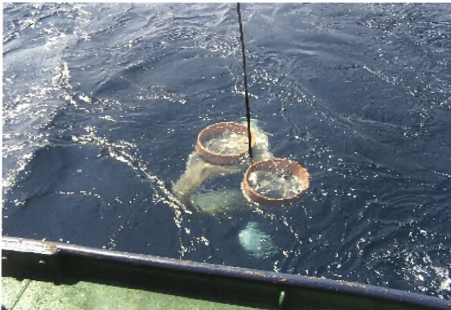
Εικόνα 12. Τα δείγματα συλλέχτηκαν με χρήση συρόμενου διχτυού τύπου «bongo net» διαμέτρου 60 cm με άνοιγμα ματιού 250 \mu\text{m} ..
