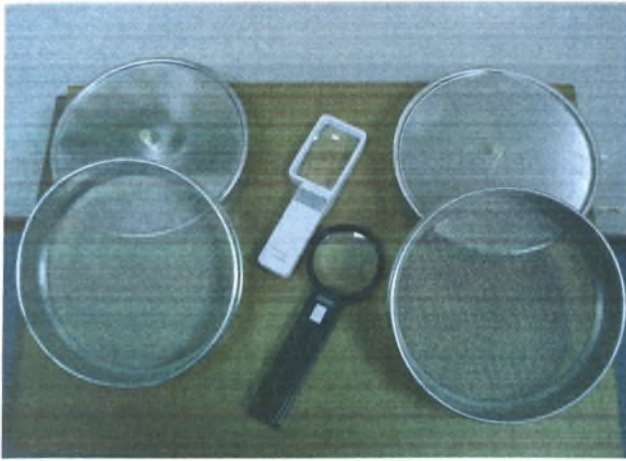
Εικόνα 4. Εργαστηριακός εξοπλισμός για την ανίχνευση των εδαφικών σπόρων από το επιφανειακό έδαφος.
