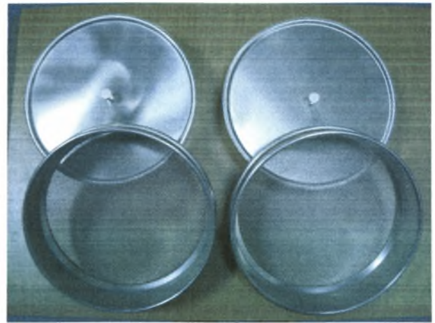
Εικόνα 3. Εργαστηριακά κόσκινα διαμέτρου 1 mm και 0,5 mm
