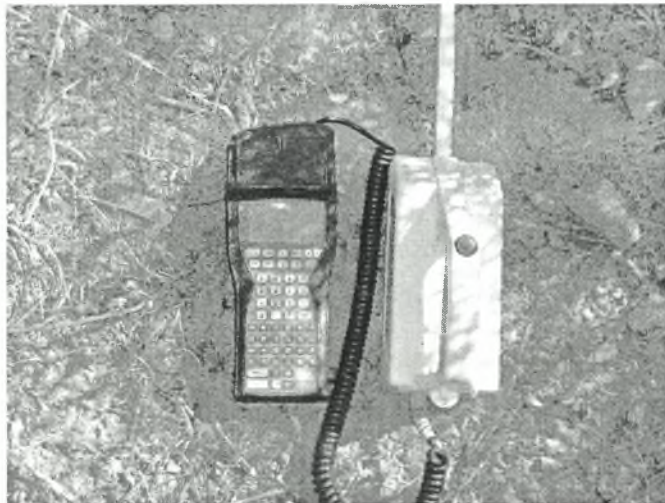
Εικόνα 3.13 Όργανο μέτρησης του Δείκτη Φυλλικής Επιφάνειας
