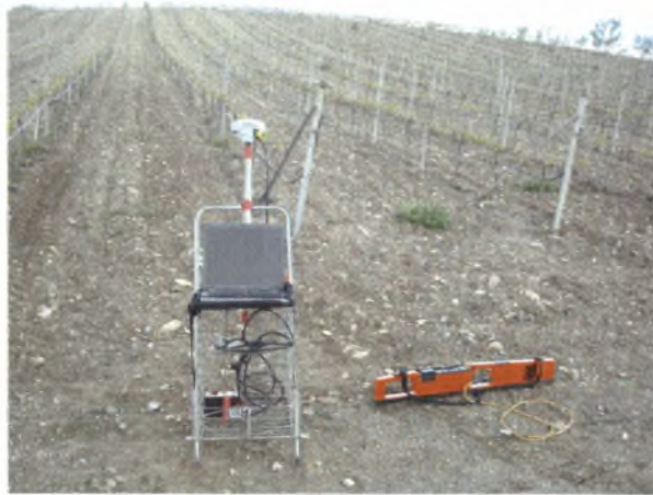
Σχήμα 3. Αισθητήρας ηλεκτρομαγνητικής επαγωγής EM 38 συνδεδεμένος με δέκτη GPS μέσω φορητού ηλεκτρονικού υπολογιστή. Το όργανο είναι τοποθετημένο στο έδαφος, παράλληλα με το έδαφος και με τη μικρού πλάτους πλευρά προς τα κάτω.
