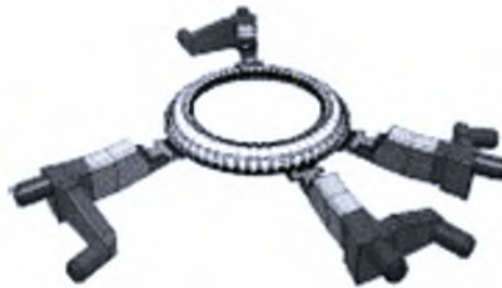
Σχήμα 1.3: Σύστημα οκτώ αντλιών κενού (exhaust pumping system).
