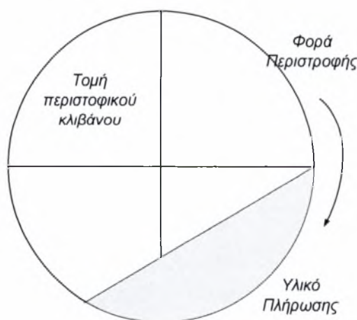
Σχήμα 2-3 Φορτίο πλήρωσης ΠΚ
