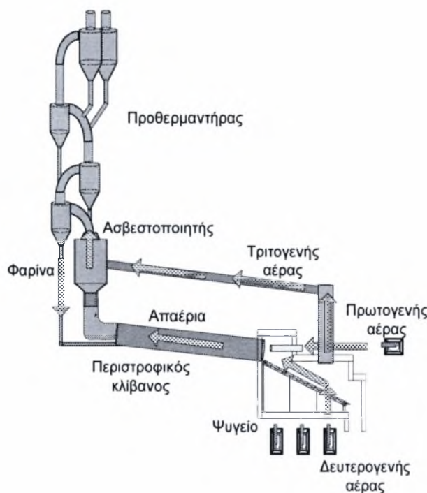
* Σχήμα 2-2 Θέση του περιστροφικού κλιβάνου
