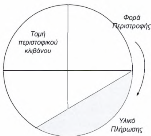
Σχήμα 2-3 Φορτίο πλήρωσης ΠΚ
