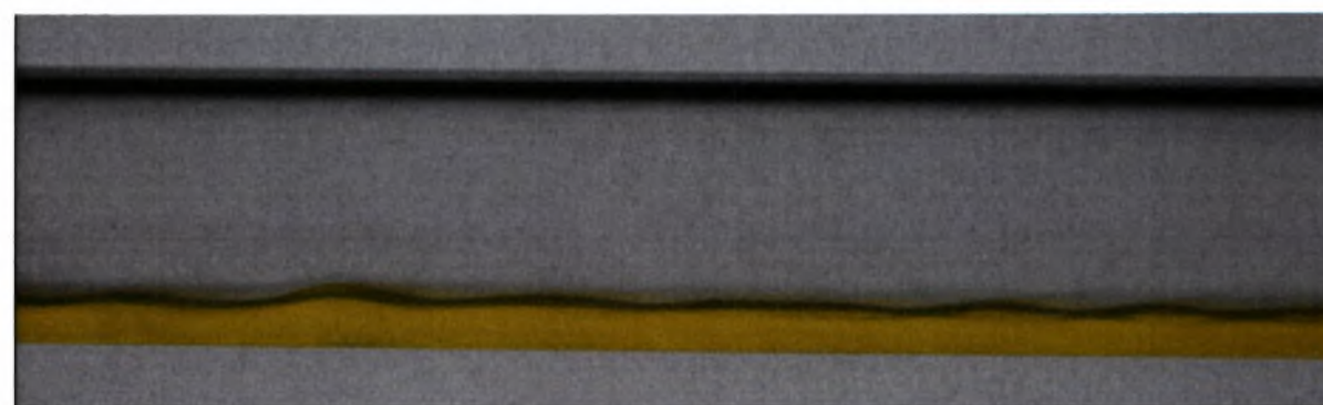
Εικόνα 6.2: Επίδραση προσθήκης πολυμερούς συγκέντρωσης 36 ppm για u_{sl}=0.011 m/s και u_{gs}=12 m/s.
