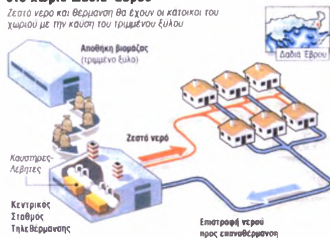
Εικόνα 23:Σύστημα τηλεθέρμανσης στον Έβρο
