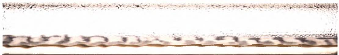
Σχήμα 4.7 Φωτογραφική απεικόνιση διαστρωματωμένης ροής με δισδιάστατα κύματα(2-D)
