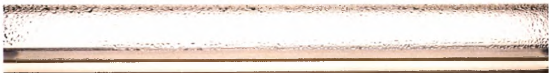
Σχήμα 4.6 Φωτογραφική απεικόνιση λείας διαστρωματωμένης ροής (smooth)
