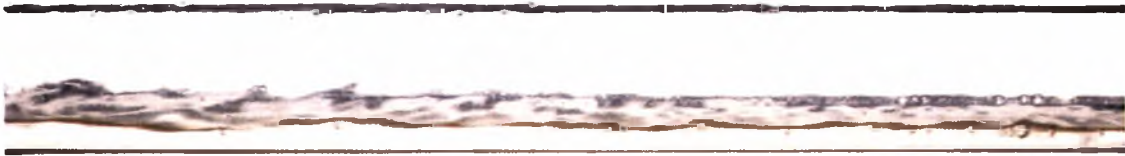
Σχήμα 4.8 Φωτογραφική απεικόνιση διαστρωματωμένης ροής με κύματα τύπου K-H
