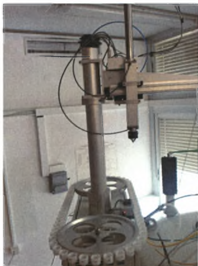
Εικόνα 22: Σημείο του μηχανήματος που τοποθετούνται τα ειδικά tubes, τα οποία περιέχουν το διάλυμα στο οποίο θα πραγματοποιήσουμε φασματοσκοπική μελέτη.
