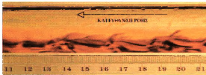
Σχήμα 4-10 Φωτογραφική απεικόνιση κυμάτων Κ - Η για ιξώδες της υγρής φάσης 46 cP
