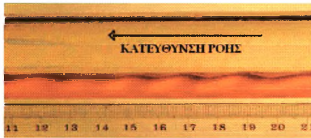
Σχήμα 4-6 Φωτογραφική απεικόνιση κομάτων 2D για ιξώδες της υγρής φάσης 46 cP
