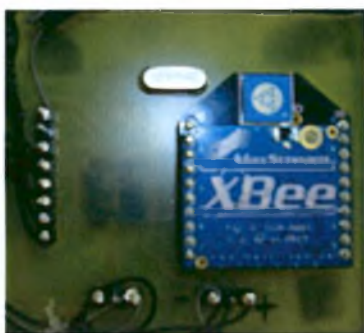
Εικόνα 22 4 η έκδοση κεντρικής μονάδας με χρήση στοιχείων επιφανειακής στήριξης
