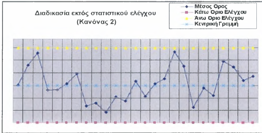
Σχήμα 2-6: Διάγραμμα ελέγχου διεργασίας εκτός στατιστικού ελέγχου (κανόνας 2 ος )
