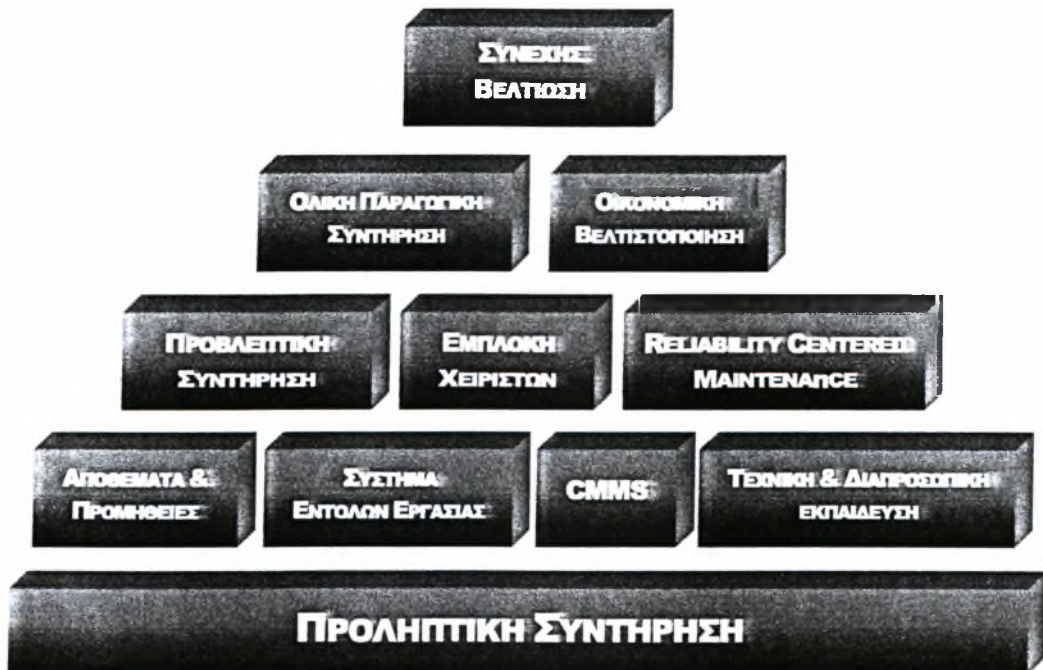
Σχήμα 2.6. Πυραμίδα Συστήματος Διοίκησης Συντήρησης
