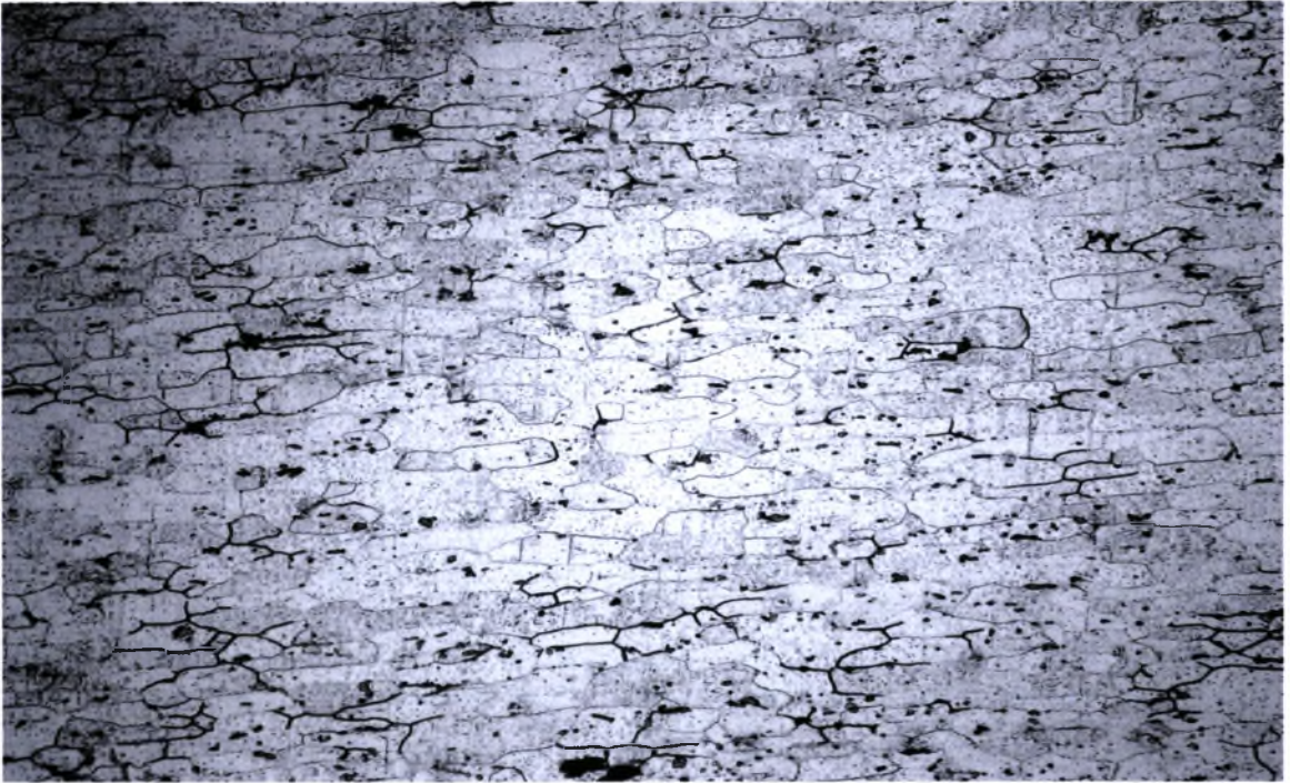
Σχήμα Β7. Φωτογραφία1 κατά τη μεταλλογραφία του τρίτου δοκιμίου κράματος 6061 με μεγέθυνση 200x.
