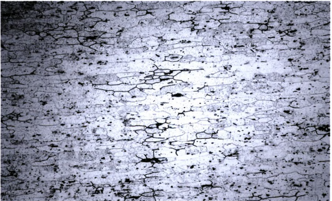
Σχήμα Β8. Φωτογραφία2 κατά τη μεταλλογραφία του τρίτου δοκιμίου κράματος 6061 με μεγέθυνση 200x.
