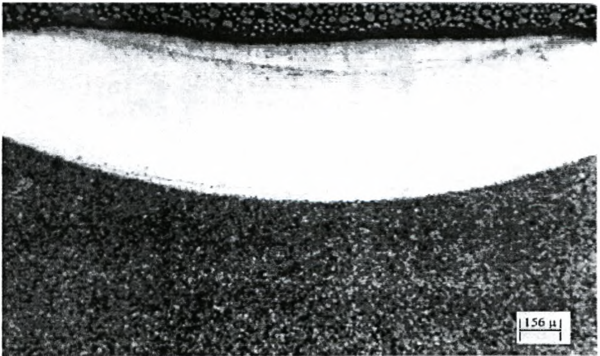
Σχήμα 1.2: Πυκνότητα ισχύος 76 \text{ W/mm}^2 , ταχύτητα δέσμης 1.6 \text{ m/min} . Η τήξη της επιφάνειας είναι εμφανής και στο δοκίμιο αυτό.
