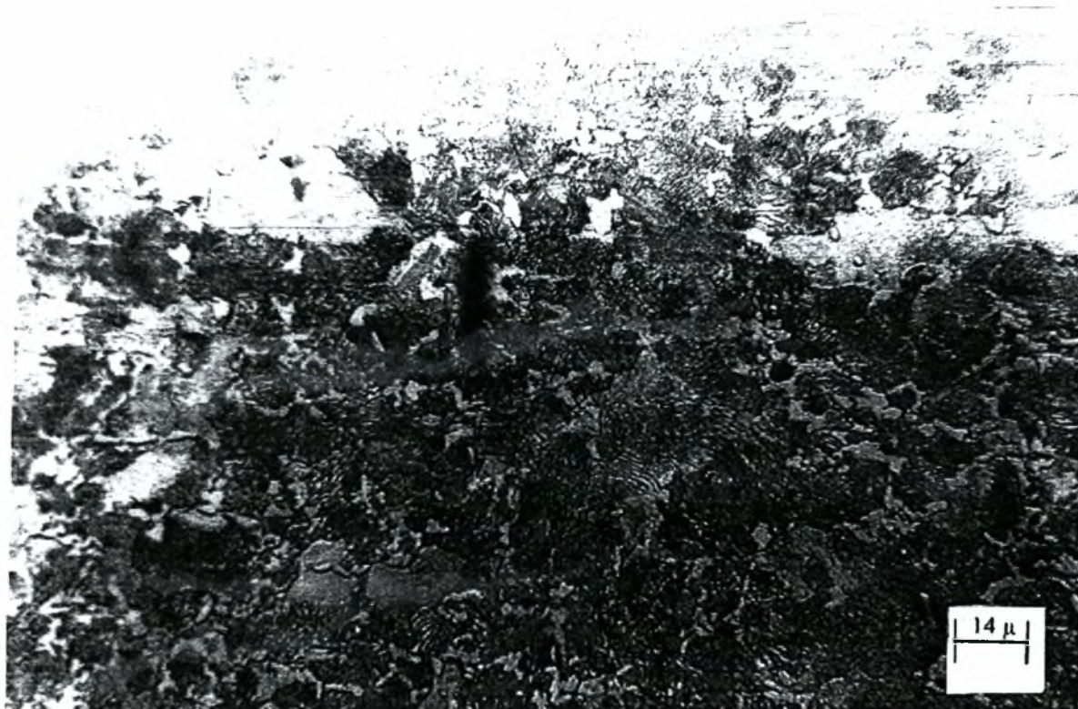
Σχήμα 2.1: Η φερριτο-περλιτική δομή του χάλυβα Ck-60.
