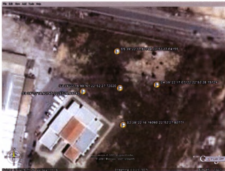
Σχήμα 14.1 Αποτύπωση αποκλίσεων GPS1 & GPS2 από βάσεις S3 και S4 αντίστοιχα.
