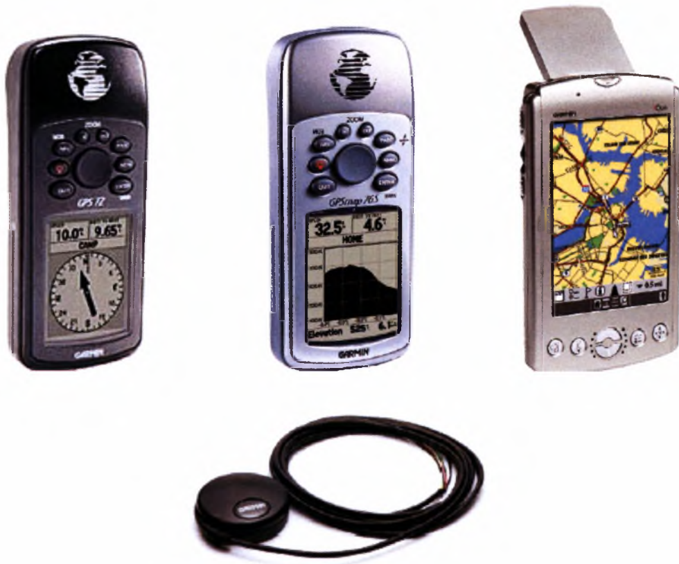
Σχ. 5.2. Φορητοί δέκτες GPS: απλός δέκτης (αριστερά), δέκτης με χάρτες (μέσον), συνδυασμός δέκτη GPS με υποφορητή συσκευή και (κάτω) εξωτερικός δέκτης GPS/RS232 κατάλληλος για σύνδεση με Η/Υ.
