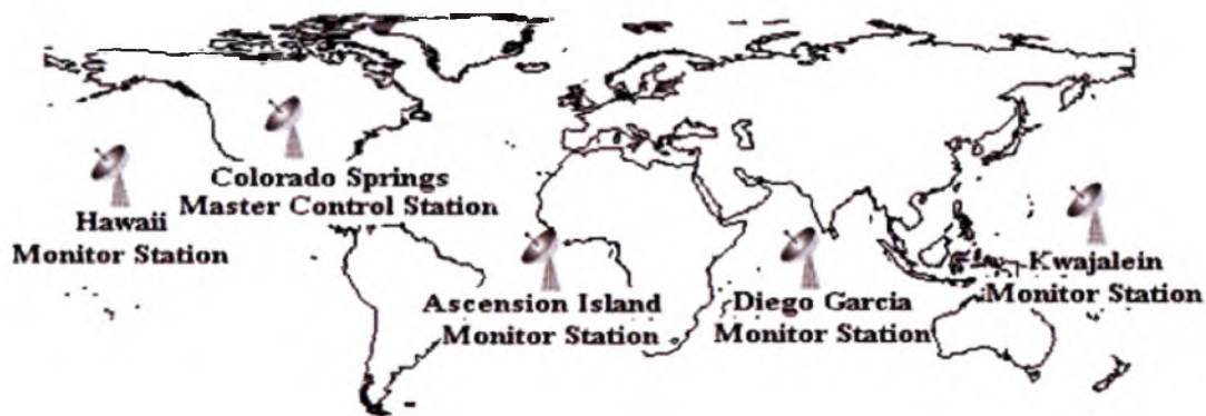
Σχ.2.3. Οι τοποθεσίες των σταθμών ελέγχου του συστήματος G.P.S
