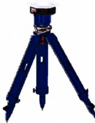
Σχ. 5.1. Κέντρωση δέκτη GPS σε τρίποδα
