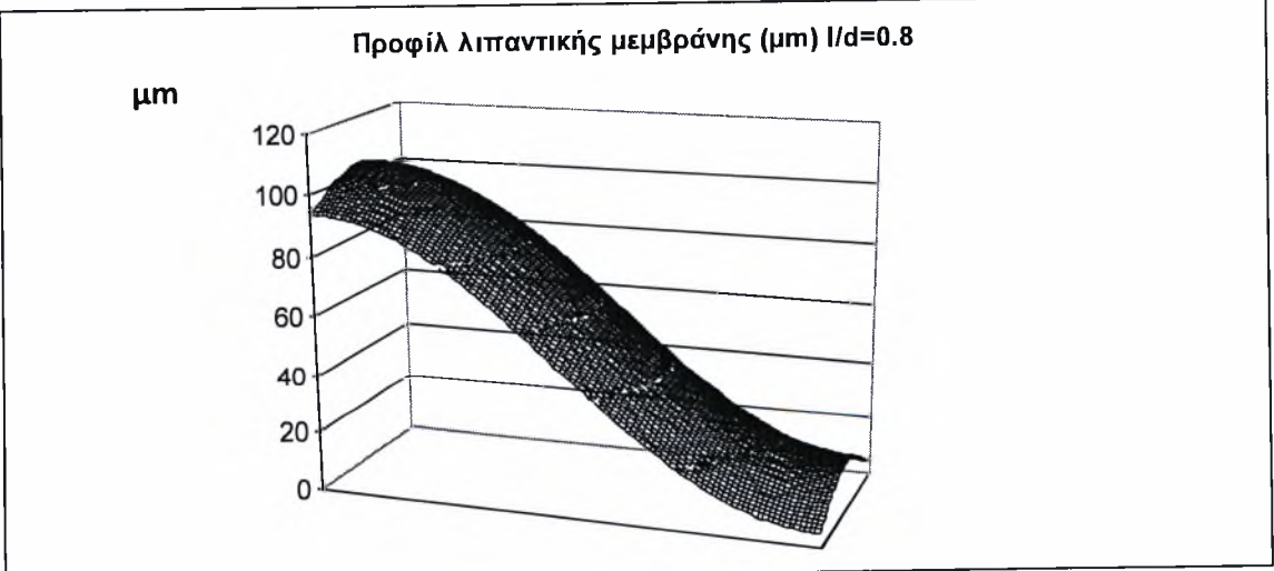
Σχήμα 3.3.β: Κατανομή πάχους λιπαντικής μεμβράνης κατά την περιφέρεια για ημιεύρος κυμάτωσης W=10 \mu\text{m} , τιμή χαρακτηριστικής λειτουργίας \eta U/w=20 , l/d=0.8 , \psi=2.0 \times 10^{-3} .
