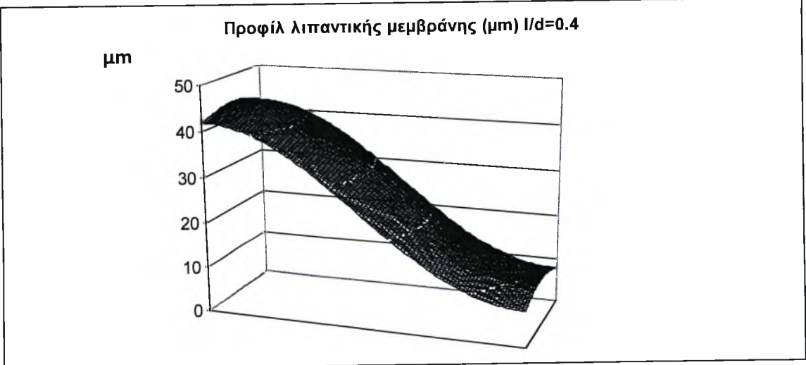
Σχήμα 3.1.β: Κατανομή πάχους λιπαντικής μεμβράνης κατά την περιφέρεια για ημιεύρος κυμάτωσης W=2 \mu\text{m} , τιμή χαρακτηριστικής λειτουργίας \eta U/w=60 , l/d=0.4 , \psi=1.0 \times 10^{-3} .
