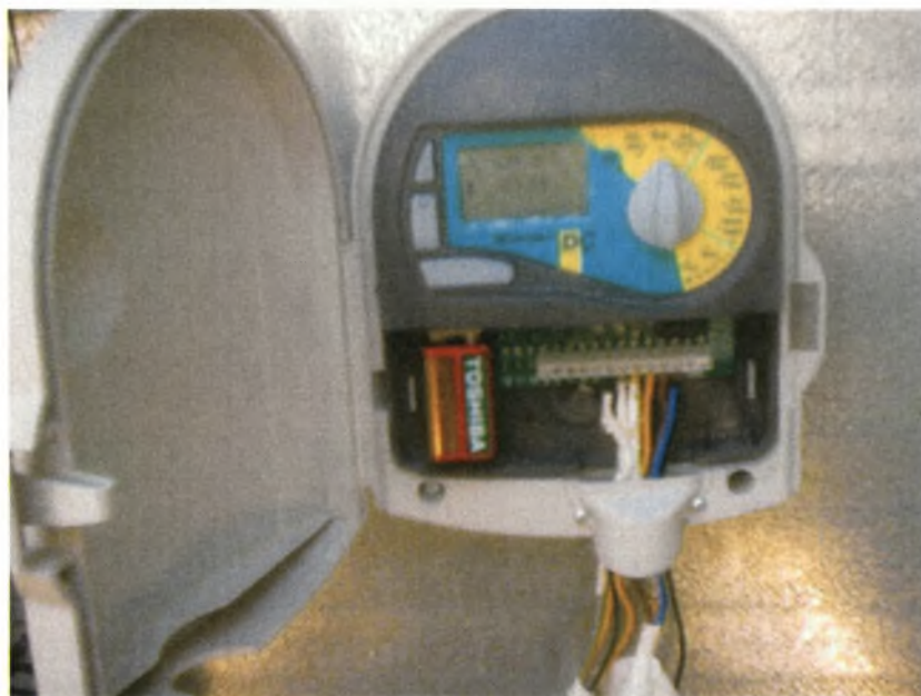
Εικόνα 4.4 Προγραμματιστής Miracle DG της εταιρείας Netafim
